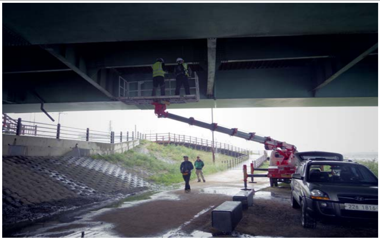
고소차를 이용한 상부비파괴 시험
